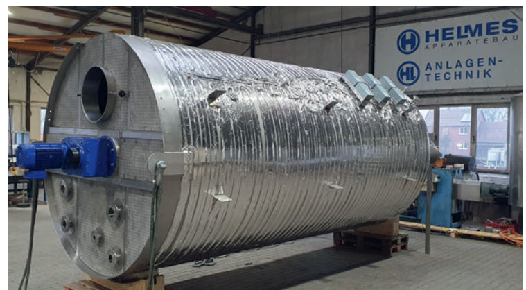
Sämtliche Schweißnähte der Edelstahlbehälter werden geröntgt, um kompromisslose Qualität zu garantieren
